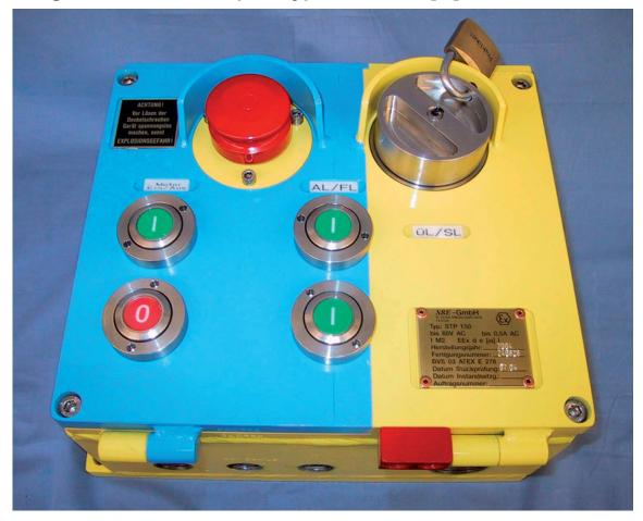
Das Steuerpult STP 150 wurde speziell für den untertägigen Bergbaueinsatz entwickelt. Durch seine kompakte und stabile Bauform kann das Steuerpult hervorragend auf ortsveränderlichen Betriebsmitteln wie Senk-, Lademaschinen, Bohrwagen und Streckenausbaubühnen installiert werden. Es ist, je nach geforderter Zündschutzart, in bis zu 10 Varianten erhältlich.
