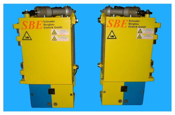
Der <u>Teilschnittmaschinenscanner</u> (TSM-Scanner) wurde speziell zur Erfassung und Bewertung von Kohlegrenzschichten für untertägige Streckenvortriebsmaschinen entwickelt. Der TSM-Scanner erfasst das Nebengestein beim Streckenvortrieb per Lasertechnik und rechnet die Daten in optimierte Schnittparameter um.
